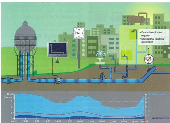
Bild 4: Arbeitsweise der vom kritischen Punkt ferngesteuerten Druckreduzierung
