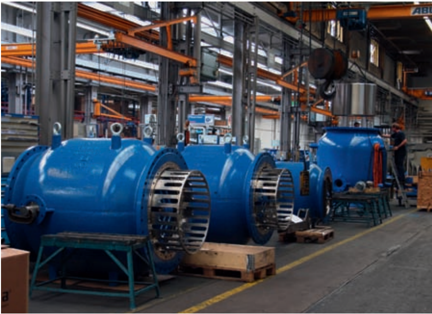
Bild 6: Montage diverser VAG-RIKO®-Ringkolbenventile DN 1 200 mit Schlitzzylindern
